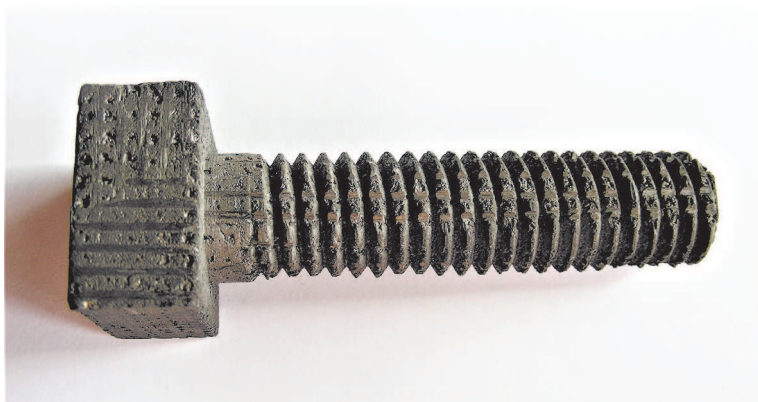
Болт из трехмерного углерод-углеродного композита
