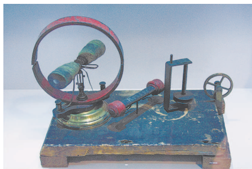
Электрический двигатель, подаренный Джоулем Кельвину в 1842 году
