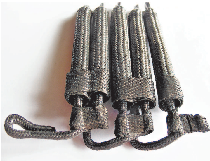
Коаксиальный нагреватель из углерод-углеродного композита. В каждом из элементов ток протекает по трубе и по центральному стержню в противоположных направлениях – это сделано для ослабления внешнего магнитного поля
