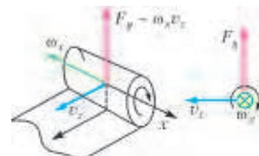
Рис.5. Векторы  $v_x$ ,  $F_y$ ,  $\omega_x$  образуют правую тройку векторов
