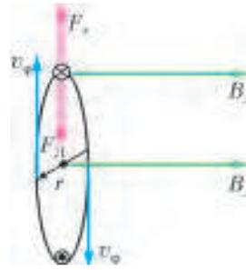
Рис.7. Положительно заряженная частица в однородном магнитном поле  $B_x$  вечно движется по окружности по часовой стрелке, если смотреть с «острия» вектора  $\vec{B}$ . Сила Лоренца  $F_L$  уравновешивается центробежной силой  $F_c$ . Обе силы — «безработные»
