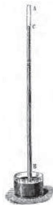
*Ртутный барометр Эванджеллисты Торричелли. Над поверхностью ртути в верхней части запаянной трубки (в области АС) – вакуум («торричеллиевая пустота»)*
