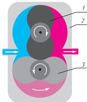
Схема роторного вакуумного насоса: 1 и 3 – лопасти, 2 – кожух
