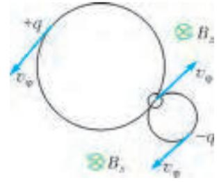
Рис.8. Пара заряженных частиц, родившаяся в результате распада материнской частицы, движущейся в начальный момент со скоростью  $v_\phi$ . Тяжелая положительно заряженная частица движется с той же скоростью  $v_\phi$  против часовой стрелки, легкая отрицательно заряженная частица — по часовой стрелке
