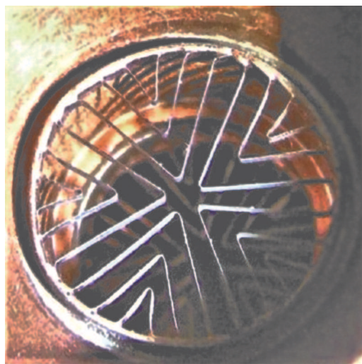
Рис. 6. Сетки из ленточек (в этой лампе было две сетки). Плоскость лент параллельна потоку электронов
