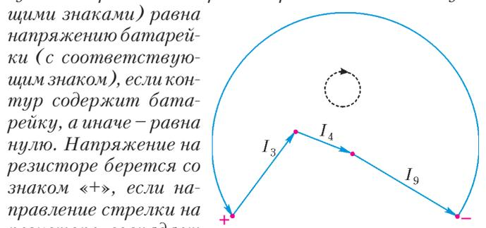
Рис.14. Второе правило Кирхгофа для контура с батарейкой:  $-I_3 - I_4 - I_9 = -1$  (учтено, что напряжение батарейки в нашем примере равно 1)
