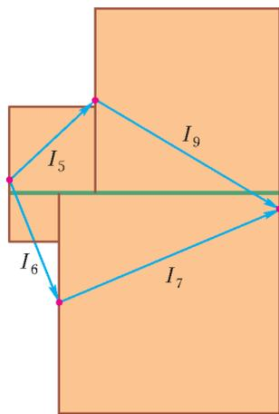
Рис.16. Второе правило Кирхгофа и условие горизонтальной стыковки
