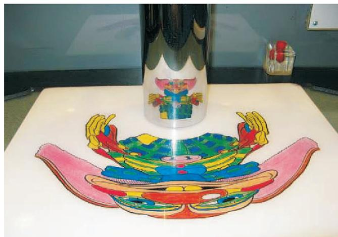
Рис.1. Использование цилиндрического зеркала в качестве анаморфоскопа
