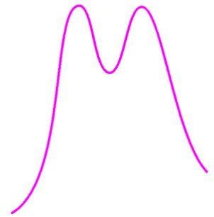
Рис.6. Сильная связь между двумя контурами
