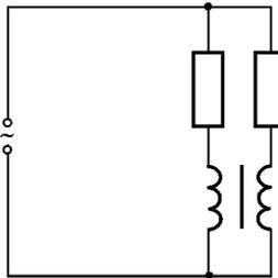
Сопротивления резисторов 1 кОм и 3 кОм, индуктивность одной обмотки 10 Гн. Цепь подключена к источнику переменного напряжения 220 В, 50 Гц. Найдите токи через резисторы.
