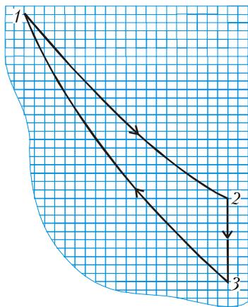
$= 0,125$ . Масштаб по оси объема: 1 дел =  $= 0,5$  л, по оси давления: 1 дел =  $5 \cdot 10^3$  Па. Найдите объем газа в изохорическом процессе. На рисунке ось давления вертикальна, а ось объема горизонтальна.
