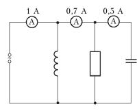
показания приборов после отключения резистора? Элементы цепи считать идеальными.
