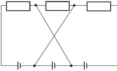
**Ф1739.** В схеме, изображенной на рисунке, все три батарейки одинаковые, напряжение каждой составляет 3 В, два резистора имеют сопротивление по 100 Ом, сопротивление третьего 200 Ом.
