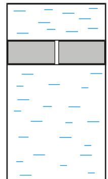
Обозначим скорость установившегося движения поршня через  $v$ . Скорость движения воды в отверстии во много раз больше – она приблизительно равна  $vD^2/d^2$  (мы не будем делать различий между величинами  $D^2$  и  $(D^2 - d^2)$  – по
