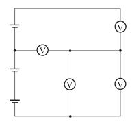
Пусть нижние вольтметры покажут U, тогда показание верхнего вольтметра составит ( $3U_0-U$ ), где  $U_0=9$  В, а показание среднего вольтметра будет ( $2U_0-U$ ). Полярность показаний вполне очевидна — стоит только мысленно разорвать цепь между точкой соединения
