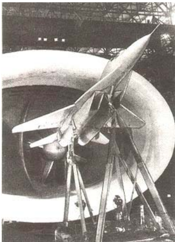
Рис.2. Легкий маневренный истребитель МиГ-29 в аэродинамической трубе
