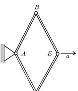
воположный шарнир Б двигают вдоль диагонали ромба с постоянным ускорением а. Вначале упомянутые противоположные вершины находятся близко друг к другу, а скорость точки Б равна нулю. Какое ускорение будет иметь шарнир В в тот момент, когда стержни АВ и ВБ составят угол 20.? Считайте движение всех точек плоским.
