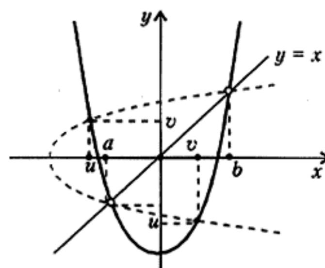
т.е. при  $q > 3/4$ . При этом  $g(u) = v$ ,  $g(v) = u$ . Все это хорошо видно из рисунка. Таким образом, точки  $u$ ,  $v$  образуют единственный цикл  $u \rightarrow v \rightarrow u$  порядка 2 отображения  $x \rightarrow g(x)$ .
