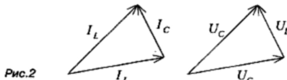
сатор — катушка», амплитуды токов всех катушек в установившемся режиме (а для нашего случая синусоидального воздействия мы интересуемся именно установившимся режимом) одинаковы, ведь элементы цепи идеальные. Вторая диаграмма соответствует напряжениям катушки и двух конденсаторов. Ясно, что сдвиги фаз на диаграммах одинаковы. Обозначив фазовый сдвиг  $\phi$ , запишем
